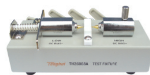
TH26008ASMD 元件测试夹具
