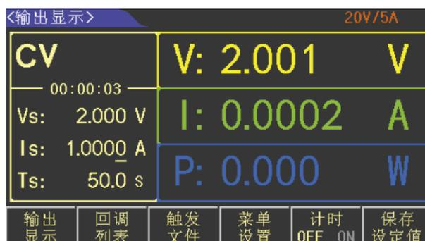
参数设置区域 工作模式 定时 测量显示区域 旋钮、数字快速输入设置参数 输出切断开关
