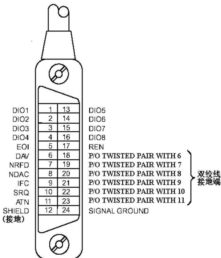
图 7-1 GPIB 接插件/管脚结构图
