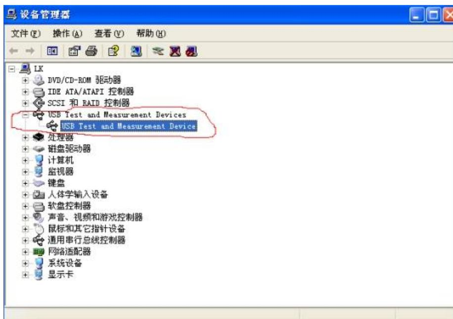
图 7-3 已安装 USBTMC 驱动资源管理器显示
