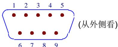
使用标准的 DB 型 9 芯孔式插头可以与之直接相连。
