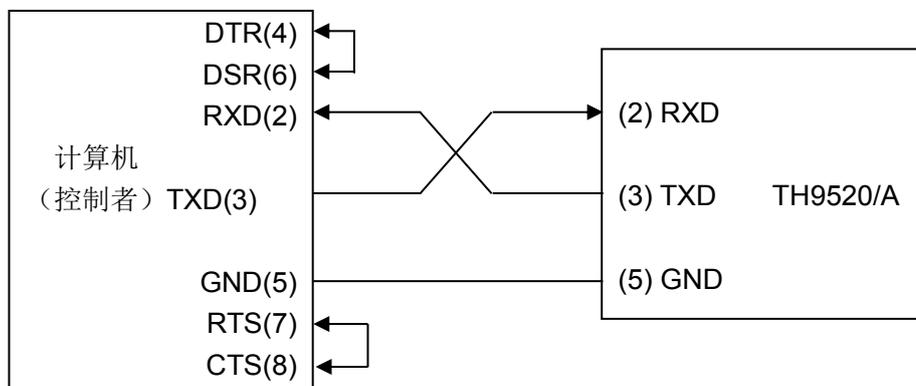
由上图可以看到，本仪器的引脚定义与 IBM AT 兼容机使用的 9 芯连接器串行接口引脚定义相同。用户可使用双芯屏蔽线按图示自行制做三线连接电缆（长度应小于 1.5m）或从同惠电子股份有限公司购买到计算机与仪器间的串行接口电缆线或直接购买标准的 DB9 芯电缆线（交叉线）。
