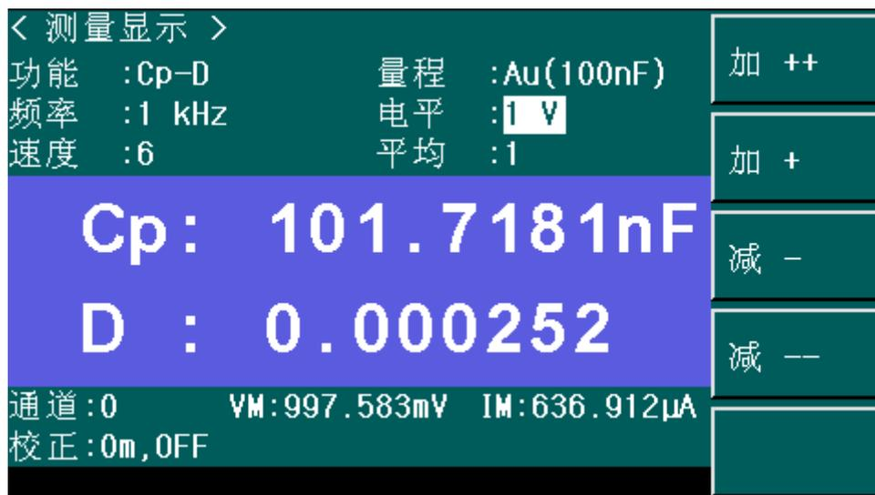
图 3-6 测量信号电平设置窗口
