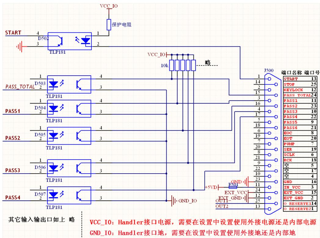
注：其中 **SCLK/RCK/SER** 三个信号，不经过上图光耦及上拉电阻，直接从 CPU 到 Handler 接口，此三个信号配合单通道比较分选板附件（详见下文）进行单通道合格和不合格信号的分选输出。
