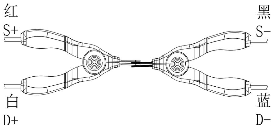
图 3-3 Alone 短路校准测试夹具连接方法
