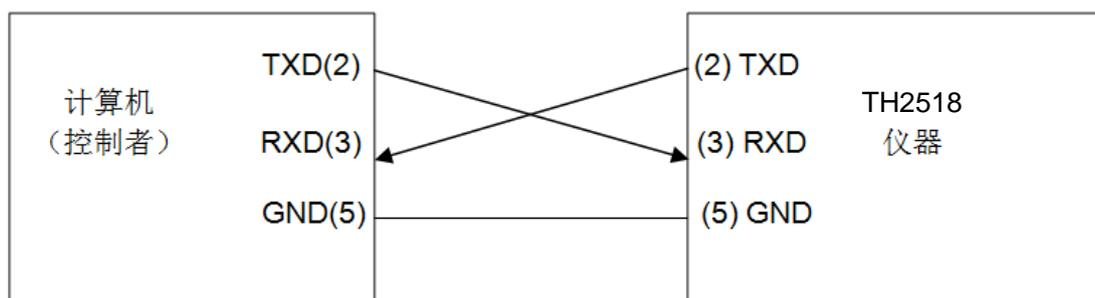
图 6-1 计算机与仪器连接示意图
