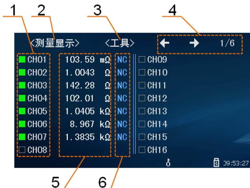
图 2-4 Scan 模式下扫描显示区域
