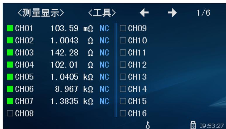
图 3-4 Scan 模式测量显示界面
