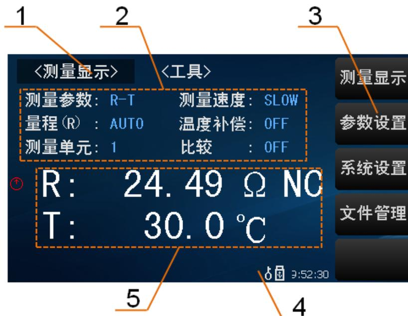
图 2-3 Alone 模式下测量显示区域
