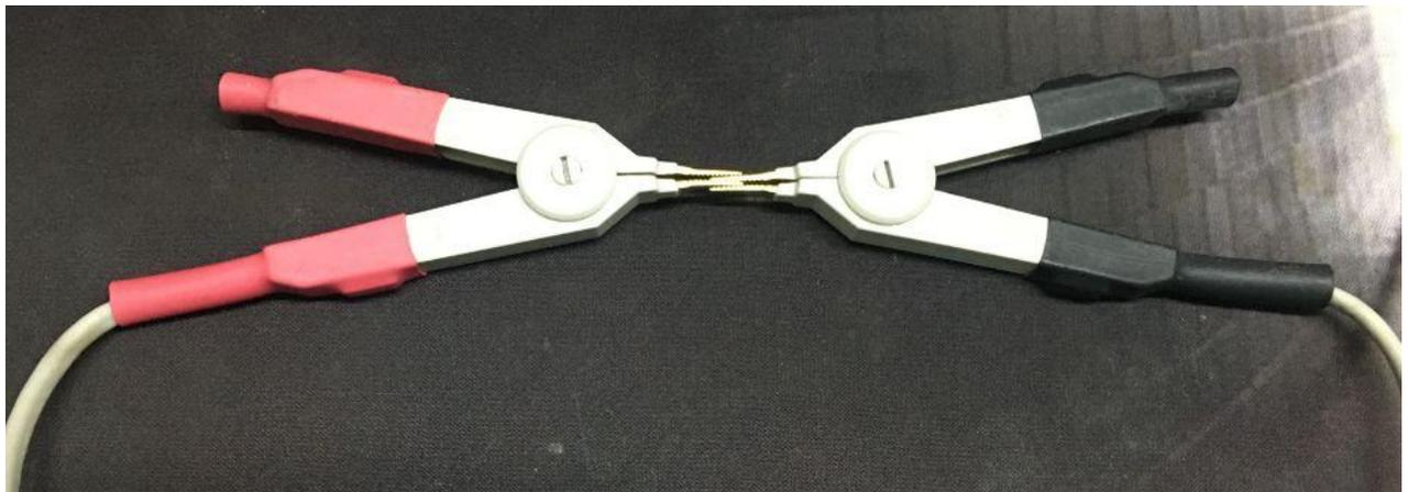
零点及清零：当使用  $200\text{m}\Omega$  量程时，应首先清零再进行测试，而在其他量程一般不必清零。测试时，选定量程，降测试端互夹，并保持接触良好，若仪器显示不为零时，按前面板清零键，则 ON 指示灯亮，仪器清零
