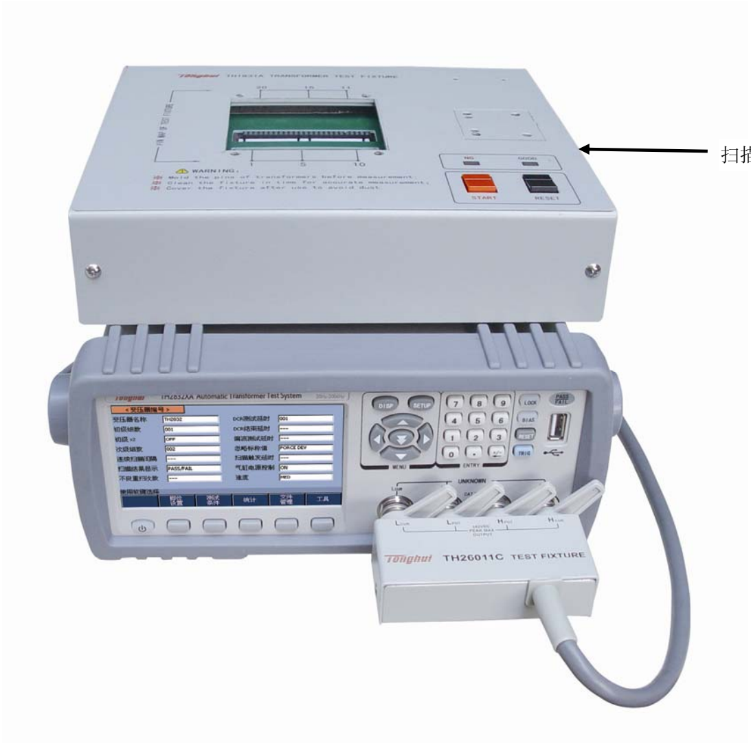
Pic702: 扫描盒测试电缆的连接
