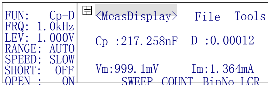
图 4-9 以小字符显示的元件测量显示页面
