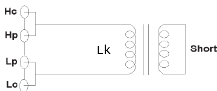
图 5—20 变压器漏感测量
